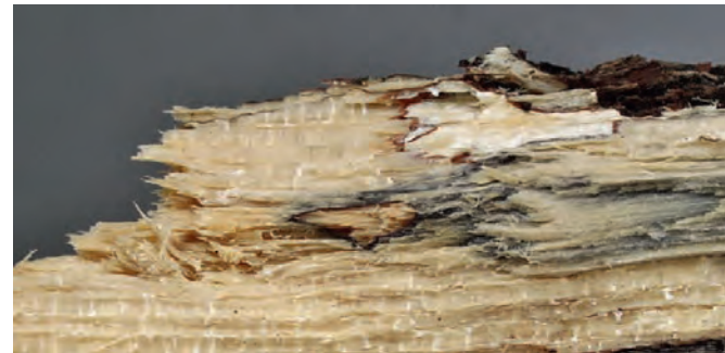
(Abb.: 3) Korrosions- oder Weißfäule
