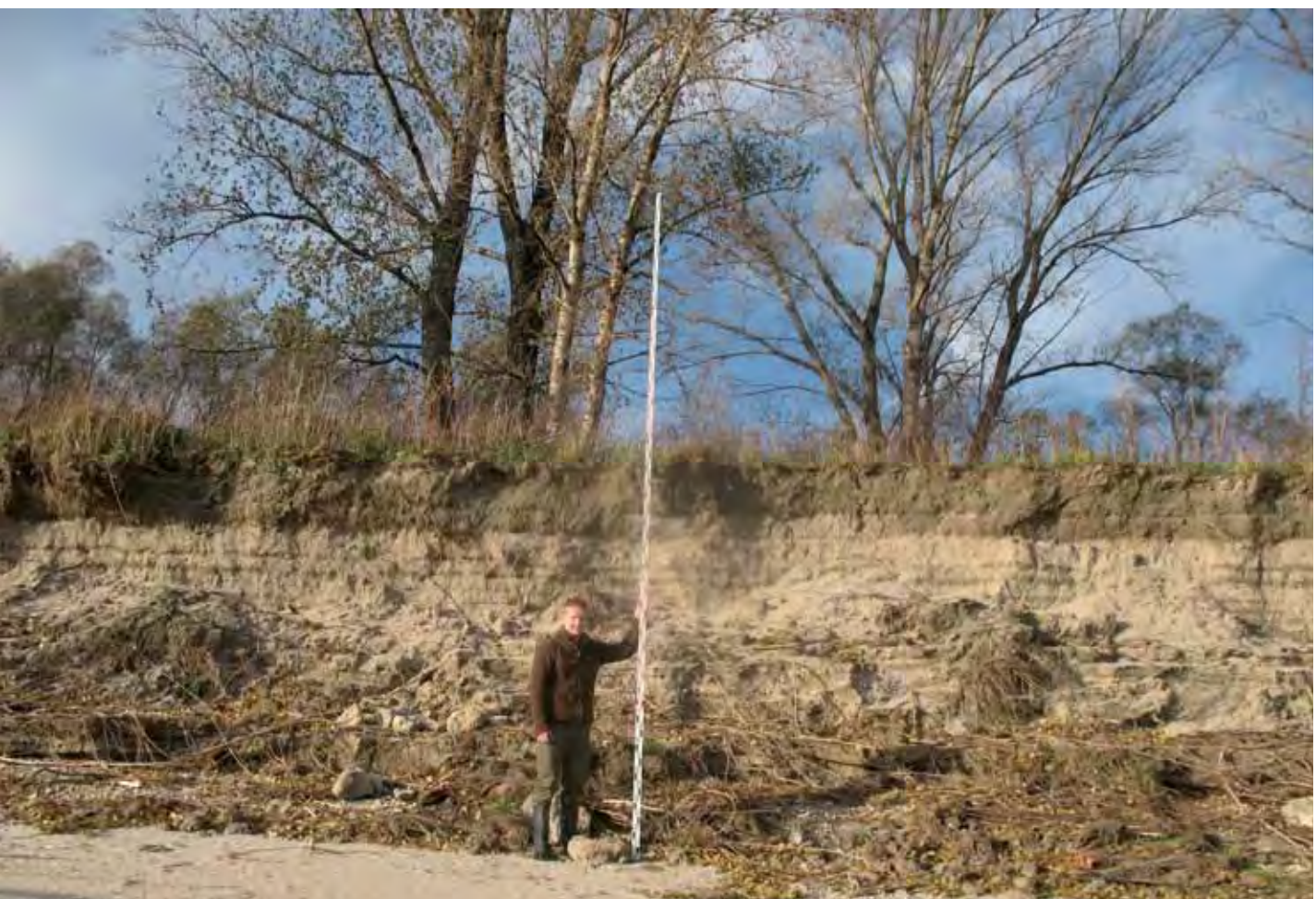
Vermessung der mächtigen Uferanrisse, die durch den Uferrückbau am Thurnhausen initiiert wurden. (Foto: Katrin Rätzsch)
