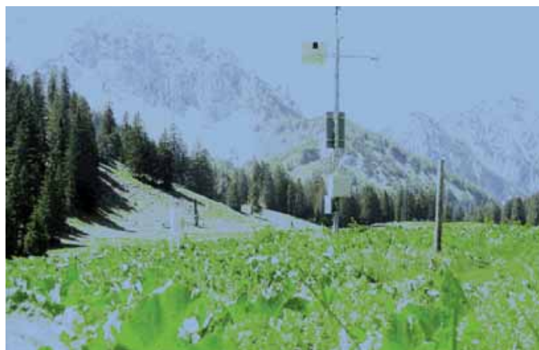
Die vollautomatische Messstation auf der Feichtaualm in 1400 m Seehöhe mit online-Übertragung meteorologischer Daten (Foto: Erich Weigand)
