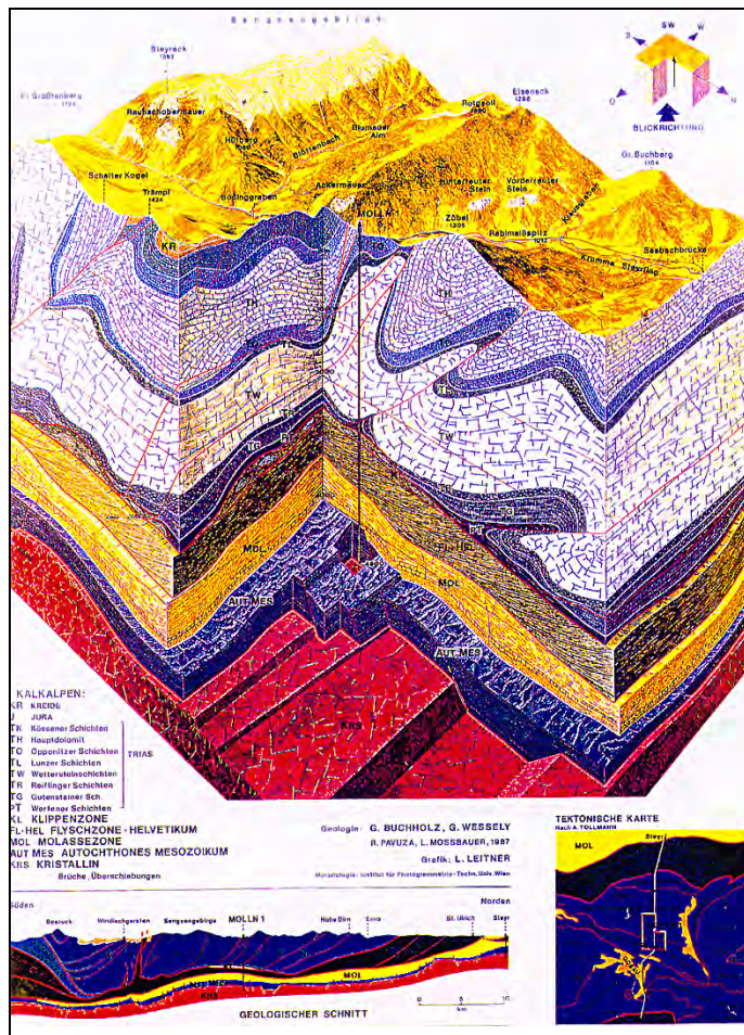
Abbildung 5: Schematische Darstellung der Ergebnisse der Tiefenbohrung „Molln“ (aus GÄRTNER ET AL., 1994).
