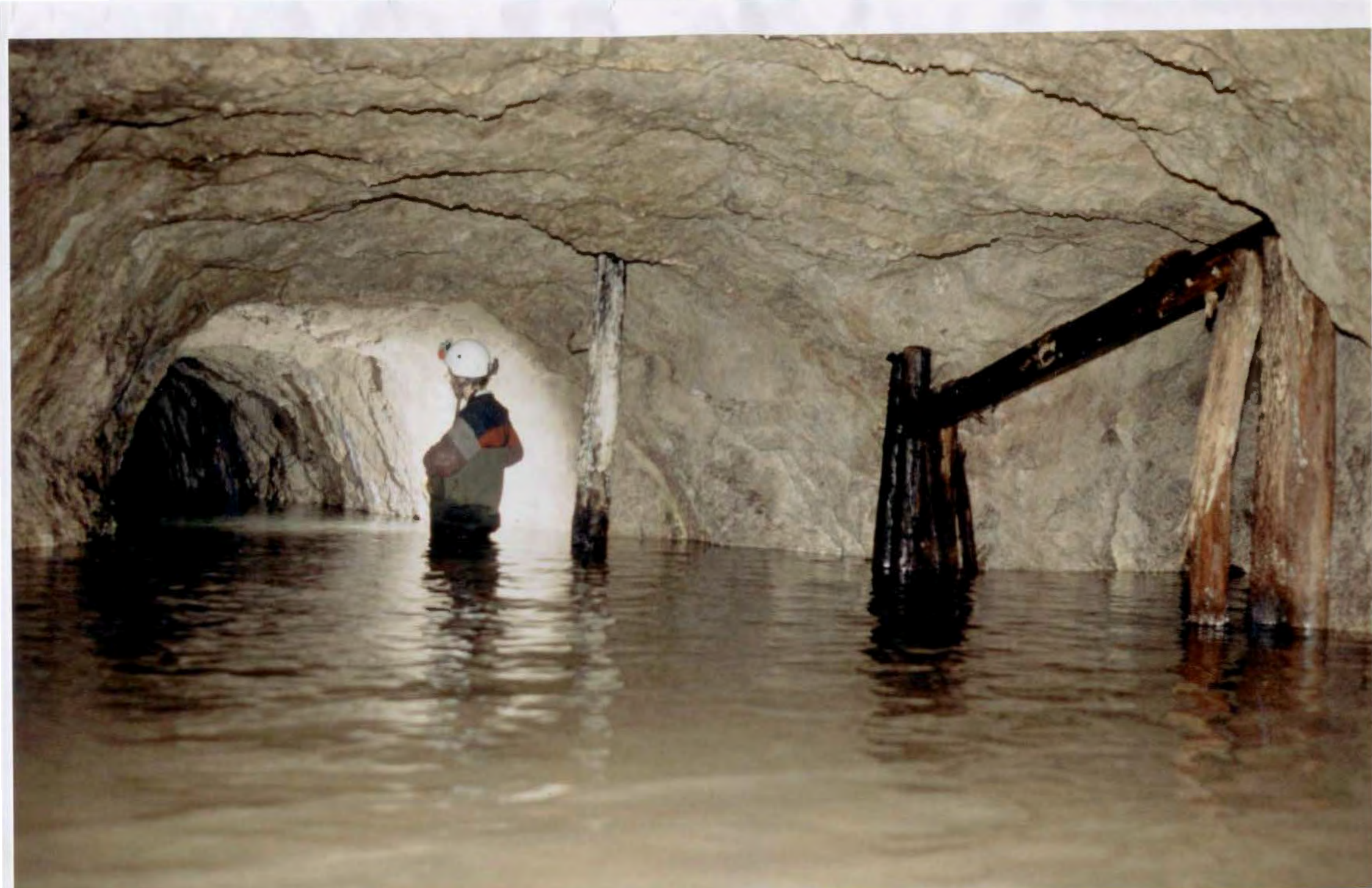
Bauxitbergbau Unterlaussa. Sonnberg-Hauptstollen. Dieser Stollen sollte die Bauxitlagerstätte des Sonnbergs unterfahren.
