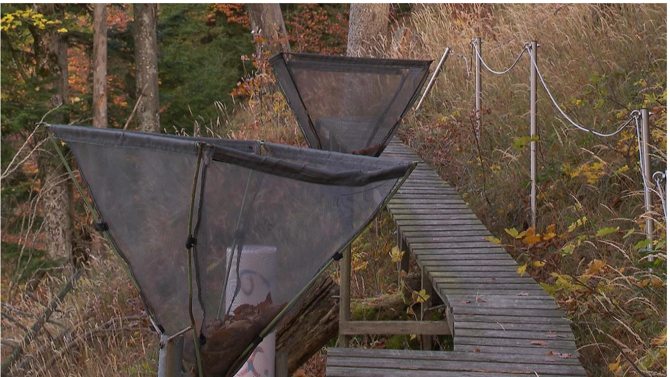
In den Trichtern aus feinem Gewebe wird das Laub aufgefangen.
