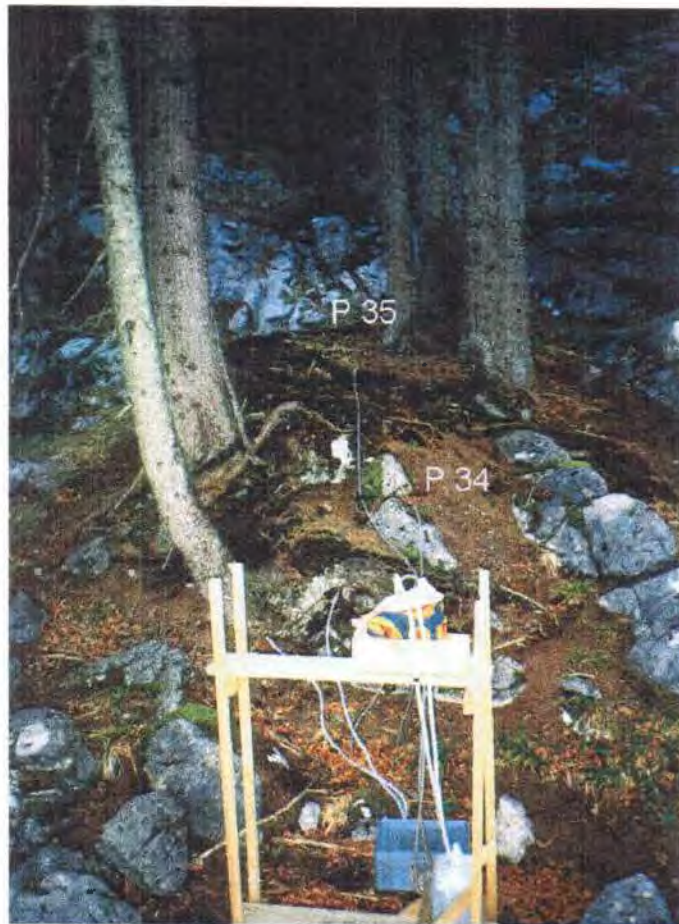
Abbildung 5-2: Teilansicht der Fichtenfläche EE – Eiseneck mit den eingebauten Plattenlysimetern P34 und P35
