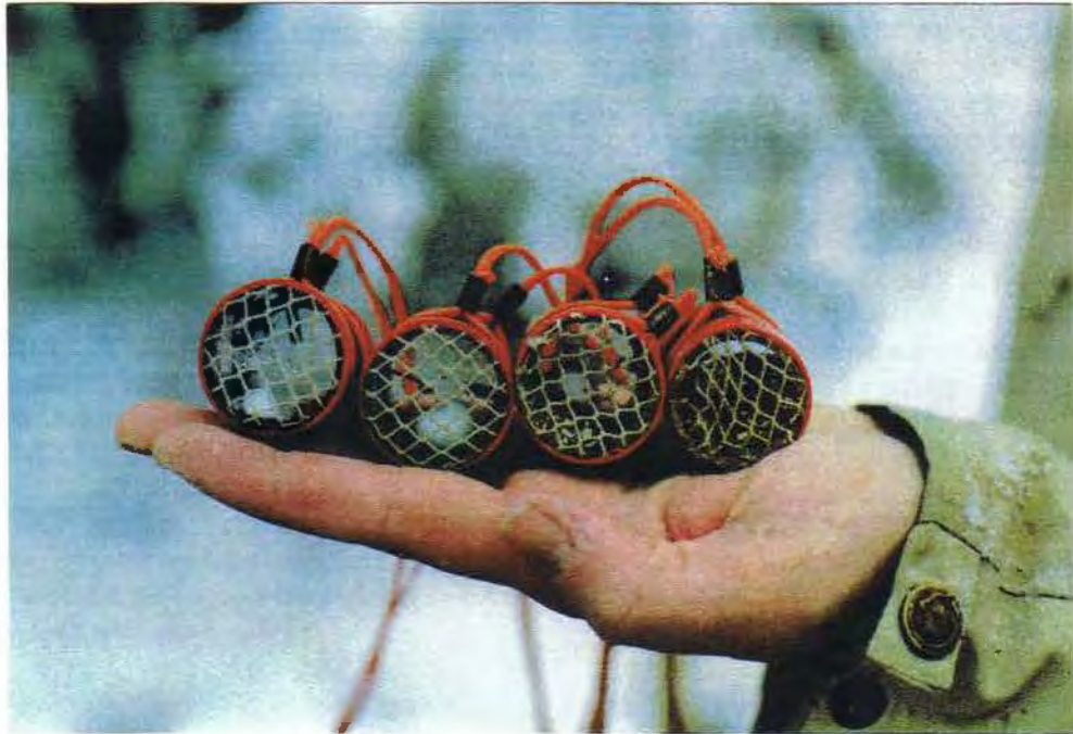
Abb.9: Gipskugelkörbchen einer Tiefenserie von einer Expositionsstelle unmittelbar nach Ablauf der dreitägigen Expositionszeit. Von links nach rechts: -5 cm, -10 cm, -20 cm, -30 cm. Tiefer exponierte Gipskugeln zeigen deutlich einen geringeren Volumsverlust. Charakteristischerweise steigt die Menge des mobilen interstitiellen Feinsedimentes (Durchmesser < 5 mm) mit der Sedimenttiefe.
