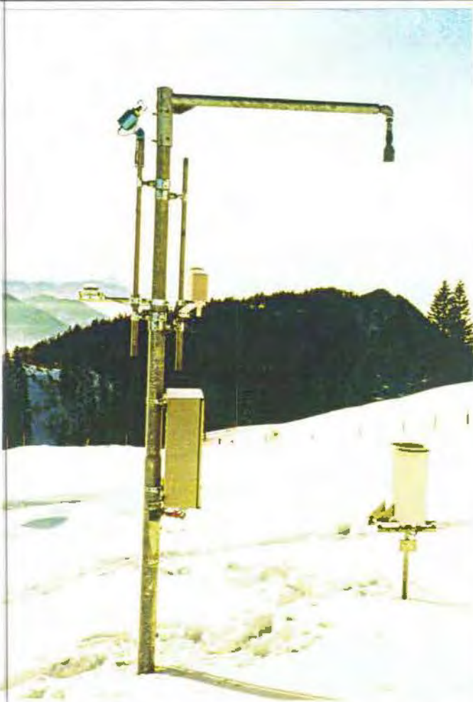
Abb. 2: Meßstelle Schoberstein mit Meßverteiler und Sensoren für Temperatur, relative Luftfeuchtigkeit, Sonnenscheindauer, Globalstrahlung, Schneehöhe, Erdbodentemperatur und Niederschlagsmeßgerät
