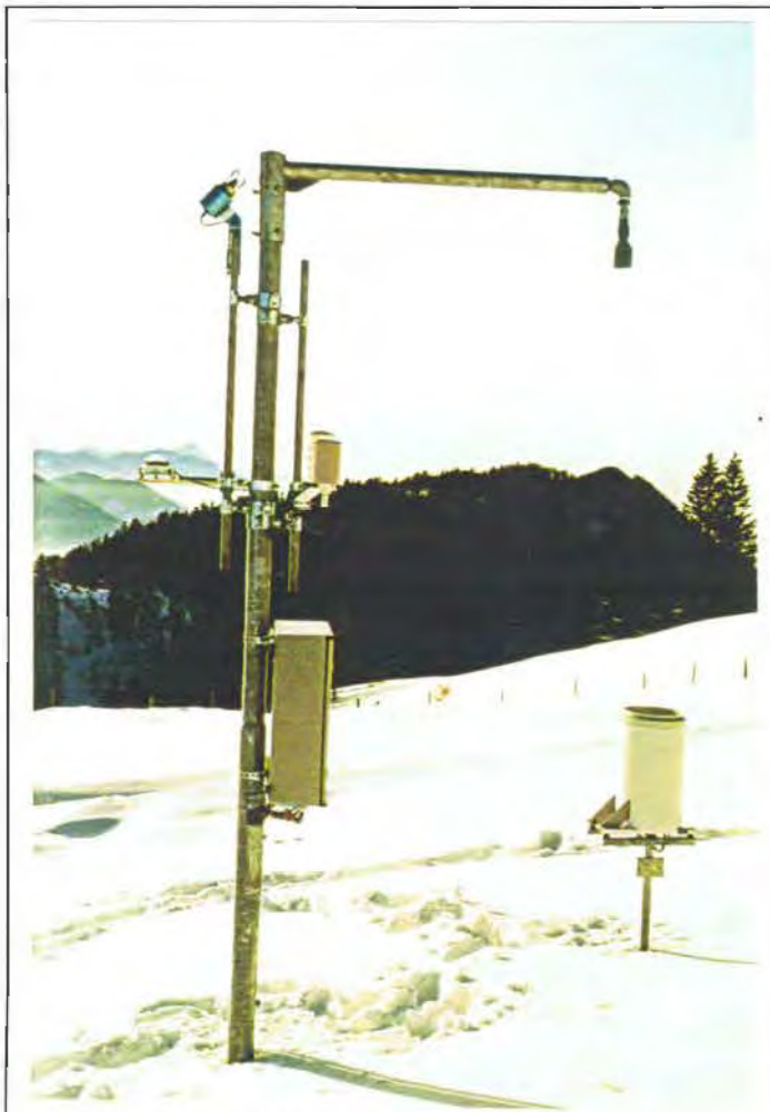
Abb. 1: Meßstelle Schoberstein mit Meßverteiler und Sensoren für Temperatur, relative Luftfeuchtigkeit, Sonnenscheindauer, Globalstrahlung, Schneehöhe, Erdbodentemperatur und Niederschlagsmeßgerät
