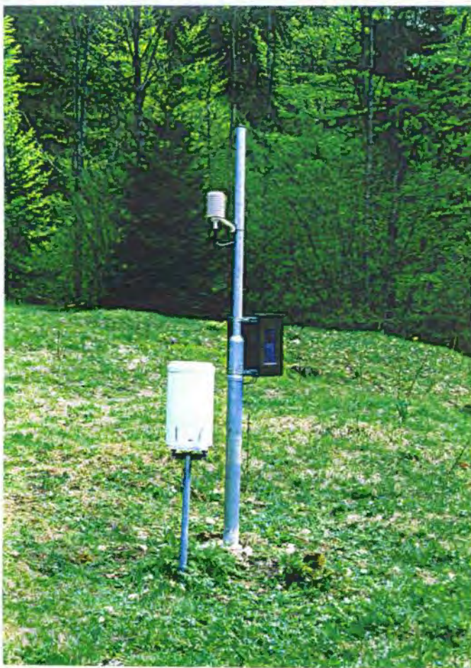
Abb. 10: Meßstelle Hinterer Rettenbach mit Meßverteiler, Solarpaneel, Sensoren für Lufttemperatur und relative Luftfeuchtigkeit und Niederschlagsmeßgerät
