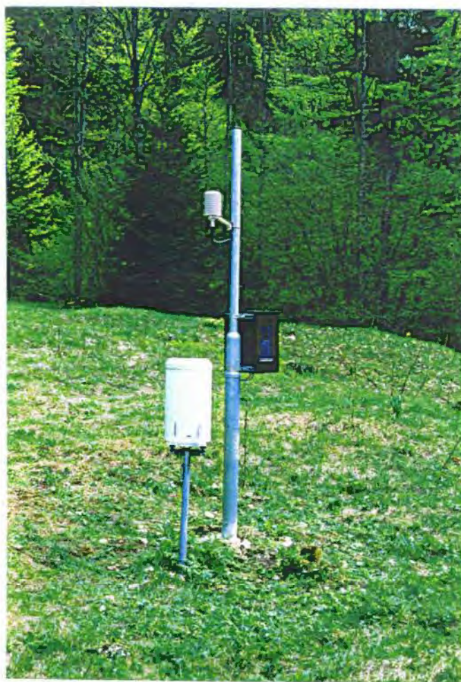
Abb. 2: Meßstelle Hinterer Rettenbach mit Meßverteiler, Solarpaneel, Sensoren für Lufttemperatur und relative Luftfeuchtigkeit und Niederschlagsmeßgerät
