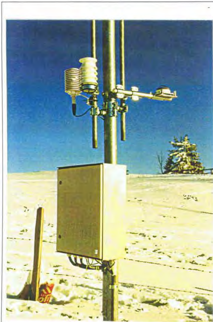
Abb. 4: Meßstelle Schoberstein mit Meßverteiler und Sensoren für Temperatur, relative Luftfeuchtigkeit und Globalstrahlung
