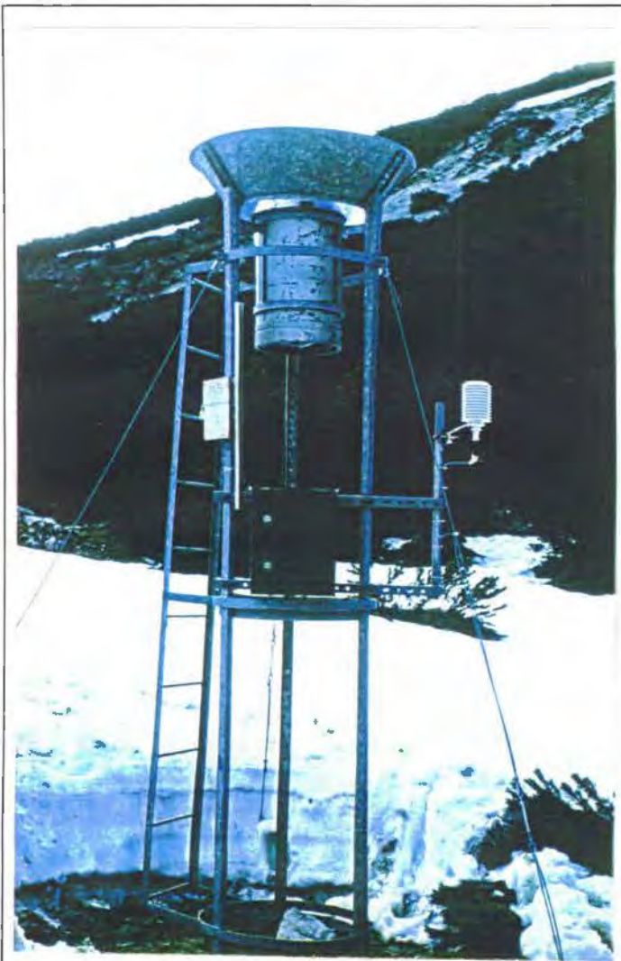
Abb. 13: Meßstelle Hagler mit Totalisator, Meßverteiler und Sensoren für Lufttemperatur und relative Luftfeuchtigkeit
