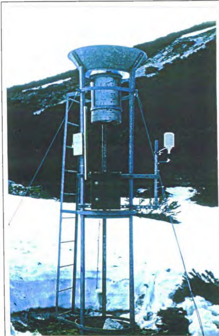
Abb. 3: Meßstelle Hagler mit Totalisator, Meßverteiler und Sensoren für Lufttemperatur und relative Luftfeuchtigkeit
