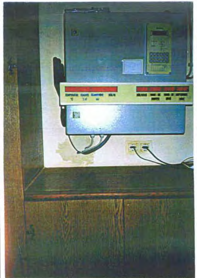
Abb. 6: Meßverteiler Schobersteinhaus mit Datenlogger DRS 16, D-Netztelefon und externer LCD-Anzeige
