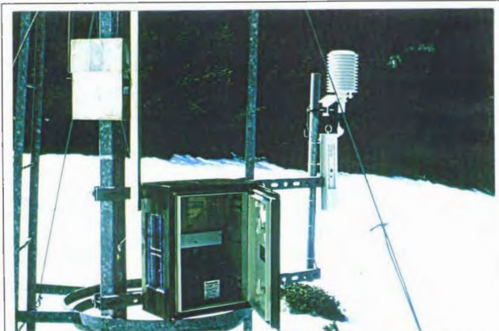
Abb. 14: Meßstelle Hagler mit Meßverteiler, Datenregistriersystem DRS 4, Solarpaneel und Sensoren für Lufttemperatur und relative Luftfeuchtigkeit
