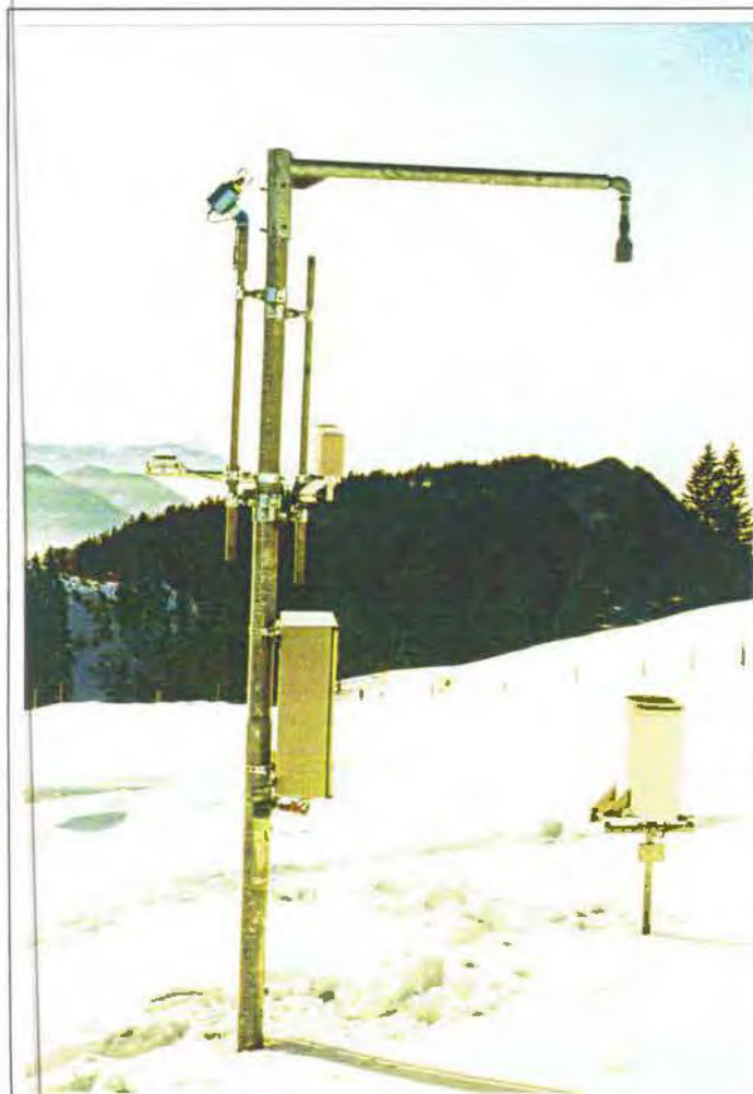
Abb. 2: Meßstelle Schoberstein mit Meßverteiler und Sensoren für Temperatur, relative Luftfeuchtigkeit, Sonnenscheindauer, Globalstrahlung, Schneehöhe, Erdbodentemperatur und Niederschlagsmeßgerät
