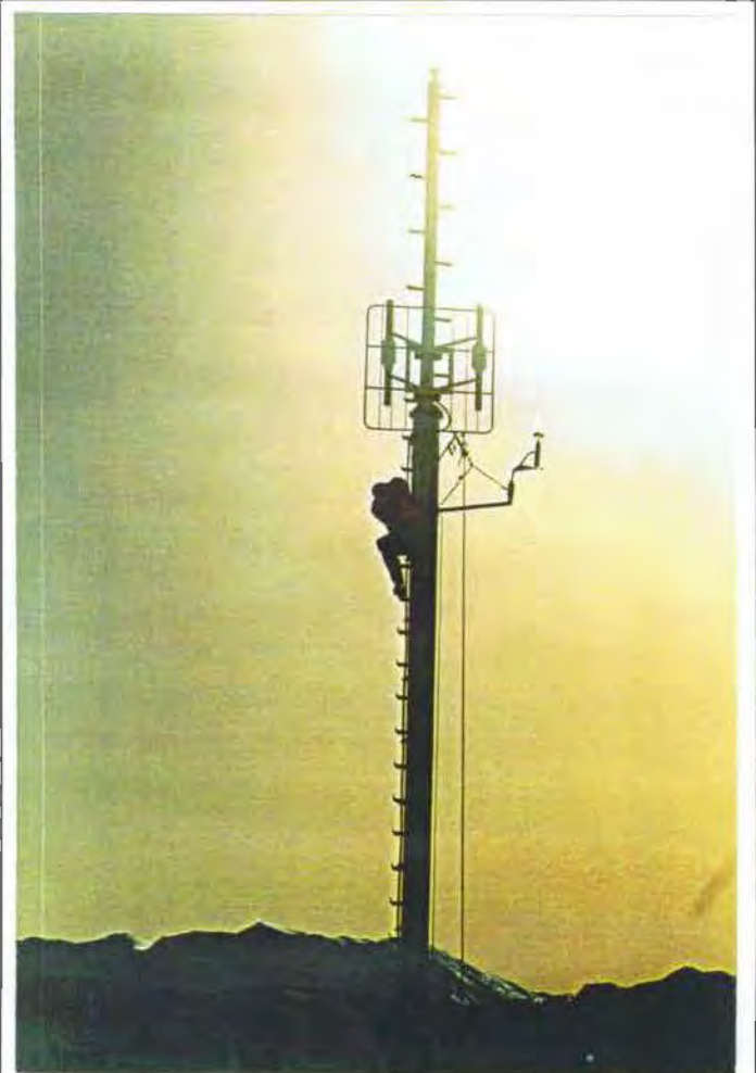
Abb. 3: Meßstelle Schoberstein am Richtfunkmast des Landesgendameriekommandos Oberösterreich mit Meßgerät für Windrichtung und Windgeschwindigkeit
