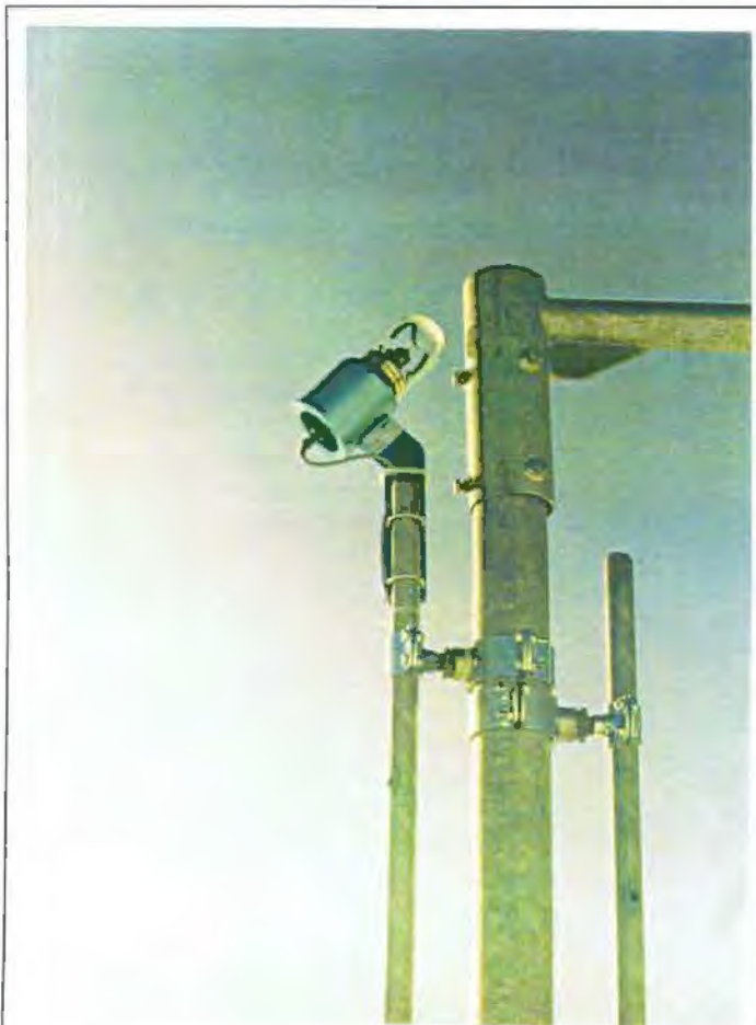
Abb. 8: Sensor für Sonnenscheindauer an der Meßstelle Schoberstein
