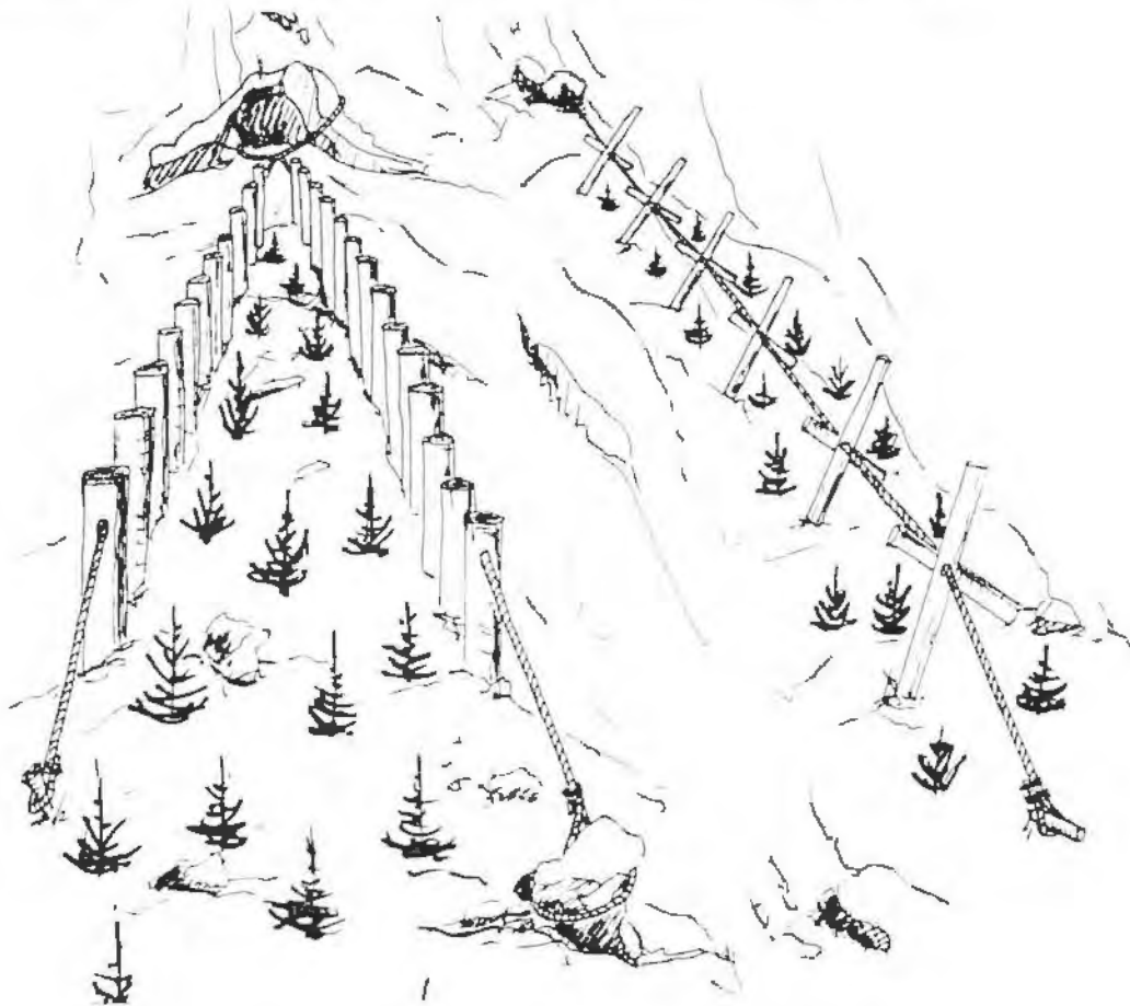
Abb. 6: Schon ein mit Rundhölzern bestücktes ausgedientes Lift- oder Seilkranseil kann von einer Verankerung aus, über eine Rippe gespannt, die Schneedecke so zerteilen, daß die Erfolgchancen einer künstlichen Verjüngung wesentlich gesteigert werden.
