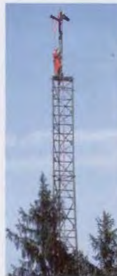
Um vom Boden unbeeinflusste Messungen der Windrichtung, Temperatur und Luftfeuchtigkeit durchzuführen, wurde vom Umweltbundesamt ein 56 Meter hoher Messturm errichtet.
