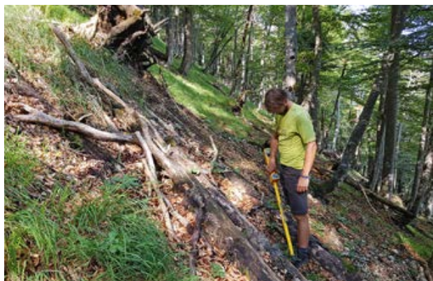
Punktaufsuche eines Inventurpunktes mit Metalldetektor.
