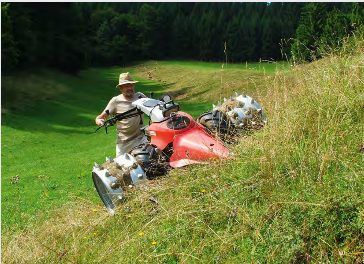
Abbildung 218: Für die Wiesenmähd auf steileren Hängen werden vorwiegend Balkenmäher verwendet.
